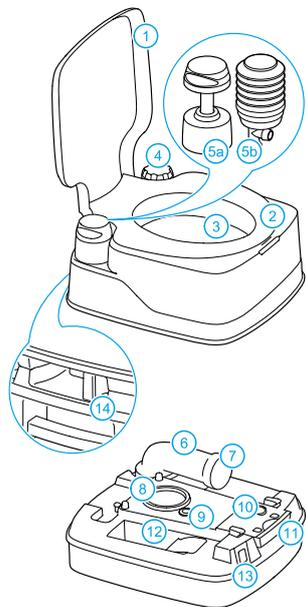
**1** Cover • **2** Seat • **3** Toilet bowl • **4** Water filler cap • **5a** Piston pump • **5b** Bellows pump • **6** Pour out spout • **7** Cap pour out spout • **8** Lip seal • **9** Vent seal • **10** Vent button • **11** Valve handle • **12** Storage for toilet fluids • **13** Level indicator waste-holding tank (dependent on model) • **14** Clasp
